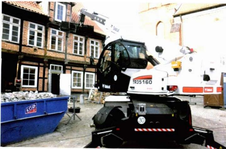
Der Teleskopausleger, die schmale Abstützung und der bis 400 Grad drehbare Aufbau prädestinieren den Roto-Teleskop TR35160 für Arbeiten unter engen Platzverhältnissen. | Foto: Bobcat
