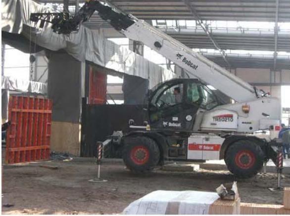
Der TR 50210 verfügt über eine maximale Hubkraft von 5 Tonnen, einer maximalen Hubhöhe von 20,50 Metern und einer horizontalen Reichweite von 16,10 Metern. Sein automatisches
