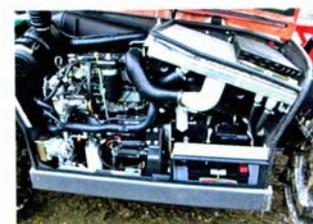
Der Vierzylinder Perkins hat 100 bzw. 130 PS im 9407S und ist jetzt längs eingebaut. Das größere Kühlerpaket wurde nach oben verlagert.
