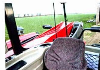
Freie Sicht! Da auch der Kabinenpfosten nach vorne verlagert wurde, ist die Sicht nach hinten rechts top.
