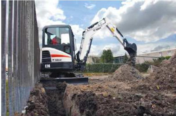
Die hohe Zuverlässigkeit des E26 basiert unter anderem auf dem "4-Plate Box"-Design der Arbeitsgruppe, den hochwiderstandsfähigen DCPD-Abdeckungen und den "Quick Lock"-Hydraulikanschlüssen. Das "4-Plate Box"-Design reduziert das Gewicht der Arbeitsgruppe. In Verbindung mit dem zusätzlichen Gewicht am Heck des Baggers konnte so der Schwerpunkt nach hinten verlagert und die Stabilität verbessert werden.
