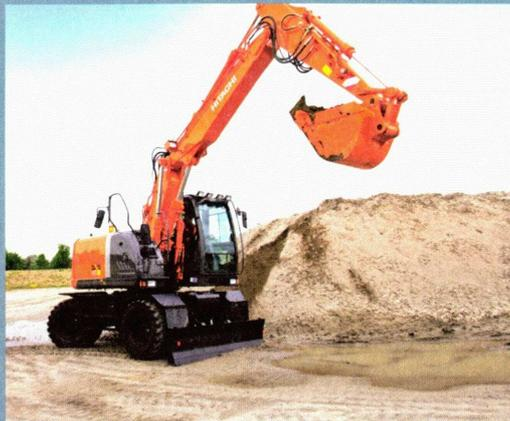
Neu im Programm von Kiesel Baumaschinen ist der Hitachi ZX145W-3, ein 15,8 bis 16,5 t schwerer Kurzheck-Mobilbagger für bis zu 5,29 m Grabtiefe und 8,96 m Reichweite
