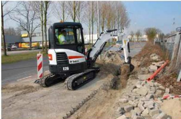
Im E26 hat der Fahrer vollständige 360° Rundumsicht sowie freien Blick auf die rechte Raupe und die Kabinenrückseite. Der Wischermotor ist an der unteren Frontscheibe montiert, um die Sicht nach vorn zu verbessern. Dazu trägt auch die auf minimale Größe reduzierte Querstrebe der Frontscheibe bei. Dank dieser Gewichtsreduzierung lässt sich die Frontscheibe nun leichter öffnen und schließen.
