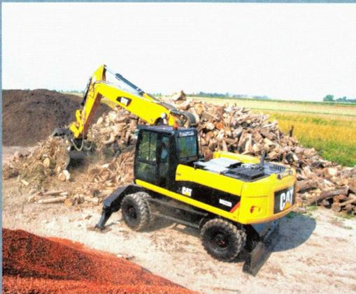
Mobilbagger wie dieser Cat M322D mit Sortiergreifer eignen sich vorzüglich für Umschlagarbeiten, da sie wechselnde Einsatzorte schnell auf eigenen Achsen erreichen
