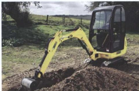
Der 1,6 t schwere 8018 von JCB ist in „Utility“-Ausführung mit vielen Extras erhältlich, neben Leitungsdetektor sogar mit Zusatzkreis für handgeführte Kleinwerkzeuge wie Hydraulikhämmer, Pumpen oder Asphalt sägen
