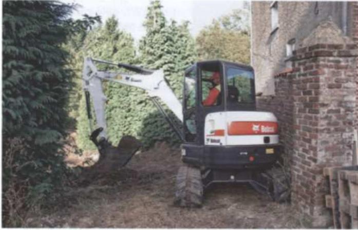
Neu bei Bobcat, nun zu Doosan gehörend, ist der 4,9 t schwere Kurzheckbagger E50; mit langem Löffelstiel erreicht er 3,92 m Grabtiefe und 4,18 m Ausschütthöhe
