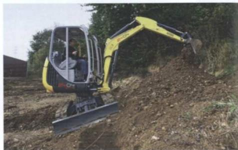
Durch VDS (Vertical Digging System) von Wacker Neuson ziehen Bagger an Neigungen und Böschungen vertikale Gräben, was unnötigen Mehrausub erspart und weniger zu verdichtetes Material verursacht
