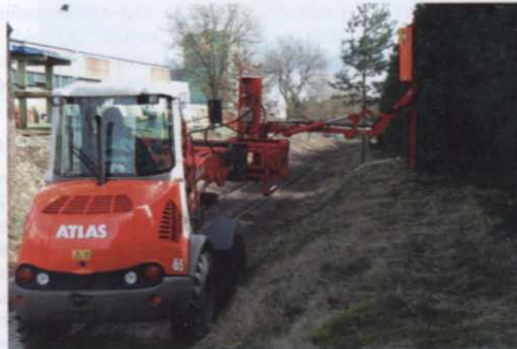
Ein AR 65 von Atlas Weyhausen trägt am Schnellwechsler ein hydraulisch stufenlos seitlich verschiebbares Baumschneidegerät und fährt damit parallel an dem zu bearbeitenden Baumbewuchs entlang Foto: Atlas Weyhausen
