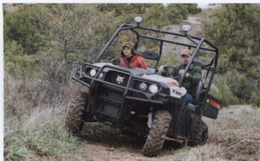
Mit seiner Bodenfreiheit von 241 mm ist der 3400D in der Lage, auch unebenes Gelände wie etwa steinigen oder zerfurchten Untergrund zu durchqueren
