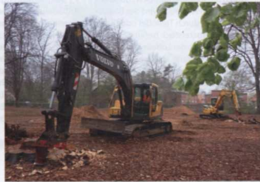
Die ohne jegliche Hydraulik arbeitende „Wurzelratte“ von Wurotec für den Schnellwechsleranbau an Bagger von 1 bis 40 t Gewicht entfernt Wurzelstöcke schneller, besser und gründlicher als mit anderen Methoden Foto: Wurotec
