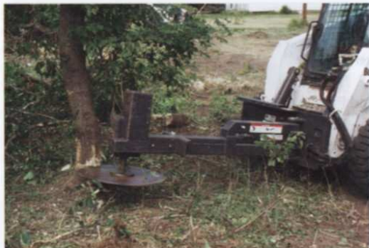
Die neue Buschsäge von Bobcat schneidet die Vegetation entlang von Straßen, Radwegen und Bürgersteigen herunter und kann dabei etwas unter dem Boden schneiden, um keine Stümpfe zu hinterlassen Foto: Bobcat
