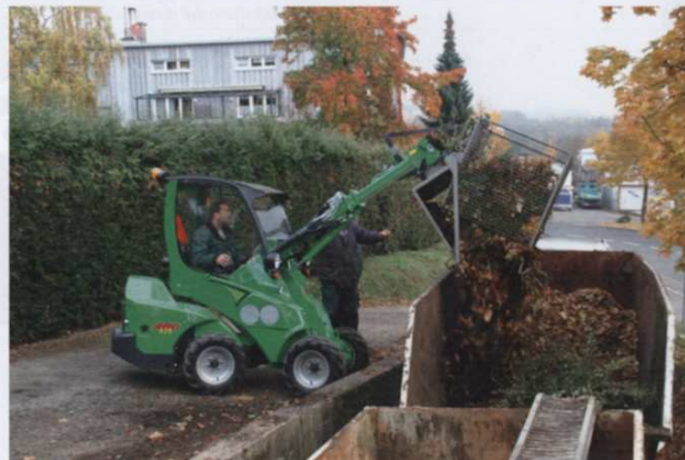
Mit optimal gewählten Anbauausrüstungen werden viele Arbeiten schneller und effizienter erledigt: dieser Laub-Kippbehälter am Avant-Lader fasst weit mehr als eine Leichtgutschaufel Foto: Avant
