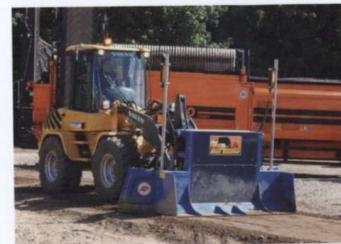
Mit dem „BullBlaster“ von AP Machinebouw (Wansor, Gevelsberg), erhältlich für 1,2 bis 2,85 m Einbaubreite, legen Radlader automatisch mittels Ultraschall oder Laser ein exaktes Planum an. Foto: Verfassers
