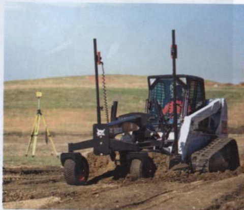
Bobcat bietet einen Anbaugrader zur Schnellwechslermontage, dessen Schar in sechs Richtungen verstellt werden kann; mit Seitenblechen ist viel Material zu befördern.
