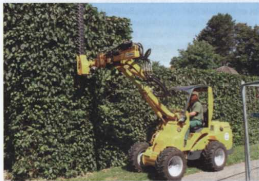
Durch den serienmäßigen Teleskoparm arbeitet der Avant 750 mit der neuen Heckenschere für 1,3 m Schnittbreite in mehr als 4 m Schnitthöhe und zertrennt Schnittgut mit bis zu 30 mm Aststärke Foto: Avant
