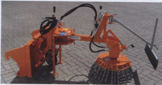
Das hydraulische Frontanbaugerät KM 20 RM von Michaelis für Rad- und Kompaktlader beseitigt schnell und wirksam Wildkraut an Fuß- und Radwegen, Straßenrändern und auch auf intensiv verunkrauteten Großflächen
