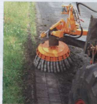
Das hydraulische Frontanbaugerät KM 20 RM von Michaelis für Rad- und Kompaktlader beseitigt schnell und wirksam Wildkraut an Fuß- und Radwegen, Straßenrändern und auch auf intensiv verunkrauteten Großflächen
