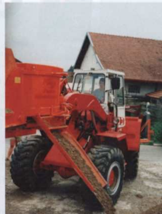
Mischschaufeln von Fliegl nehmen Material selbsttätig auf, mischen während der Radladerfahrt Beton, Mörtel, Estrich und sogar erdfeuchte oder großkörnige raue Mischgüter und verarbeiten Kies, Sand, Split, Zement und Erde
