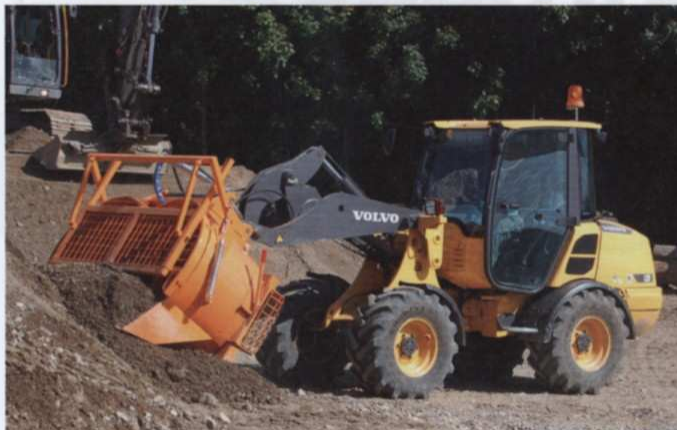
Mischschaufeln von Fliegl nehmen Material selbsttätig auf, mischen während der Radladerfahrt Beton, Mörtel, Estrich und sogar erdfeuchte oder großkörnige raue Mischgüter und verarbeiten Kies, Sand, Split, Zement und Erde
