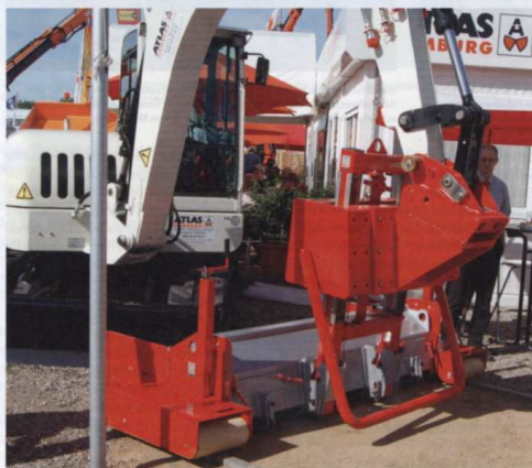
Mit dem rollengeführten planierFix PL200X3 für 2,15 bis 3,3 m Arbeitsbreite kann nun auch ein Raupenbagger der 7- bis 9-t-Klasse ein exaktes Planum anlegen, bei Bedarf mit Laser- oder GPS-Steuerung. Foto: Verfassers
