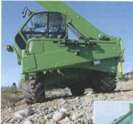
Ausgleich: Der bis zu 40 km/h schnelle Roto 6024 MCSS von Merlo kompensiert mit Niveaueingleich und Schwingungsdämpfung Unebenheiten beim Lastentransport und beim Drehen des Oberwagens auch die Querneigung der Standfläche.
