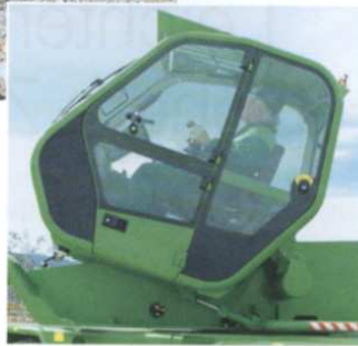
Aufwärtstrend: Der Roto 60.24 MCSS, mit 6 t Tragkraft und knapp 24 m Hubhöhe der stärkste Drehteleskop von Merlo, kann seine Kabine hydraulisch nach oben kippen und so dem Fahrer die Sicht in die Höhe erleichtern.
