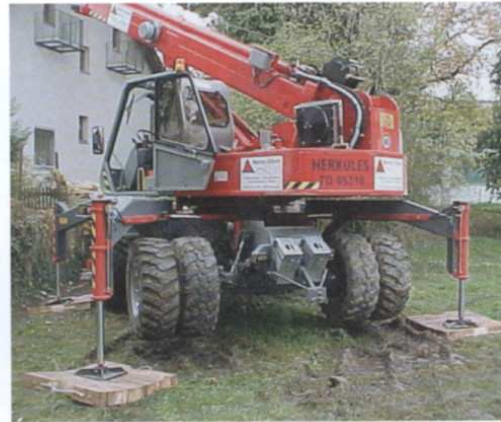
Telekatze: Mit dem Gittermast-Kranarm samt Laufkatze am Hubmast verwandelt sich der Roto von Merlo vom Teleskopstapler zum radmobilen Hochbaukran.
