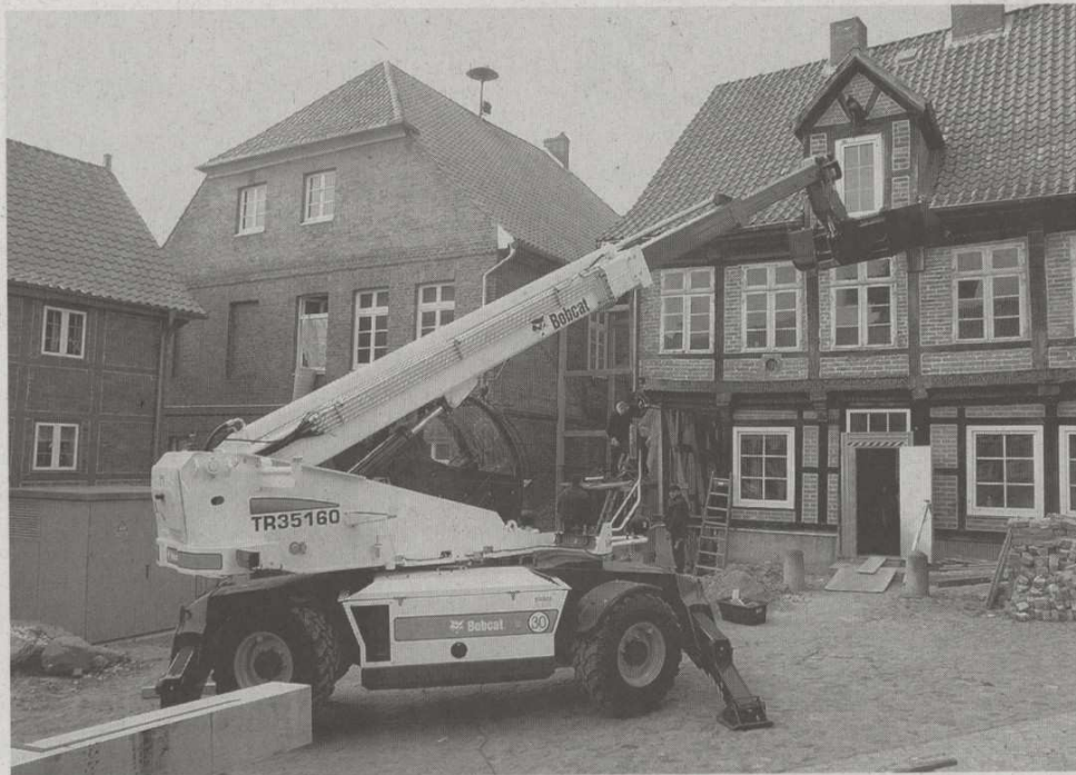
Der TR35160 arbeitet auf der Baustelle mit einem Kranarm mit integrierter Seilwinde, Palettengabel und einer Schüttgutschaufel. Foto: Bobcat
