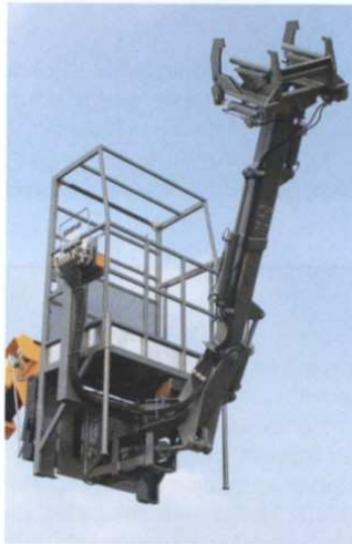
Röhrenarbeiter: Gute Arbeit leisten Drehteleskopen auch im Tunnelbau. Dieci hat einen Personenkorb mit einem schwenkbaren hydraulischen Greifarm zum Setzen von Tunnel-Ausbaubögen ausgestattet.
