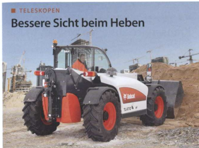
Im Glashaus: Der Blick nach rechts hinten wird von keiner Kabinenstrebe gestört, und auf Wunsch ist die linke Türe der neuen Bobcat Teleskopen TL360 und TL470 komplett verglast. Das verbessert auch die Sicht auf den Bereich unmittelbar neben den Rädern erheblich.
